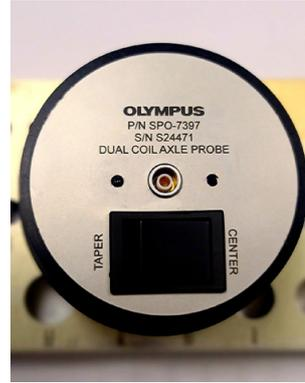
Configurazione di sonda per l'ispezione di difetti nella parte centrale di un asse di veicolo ferroviario
